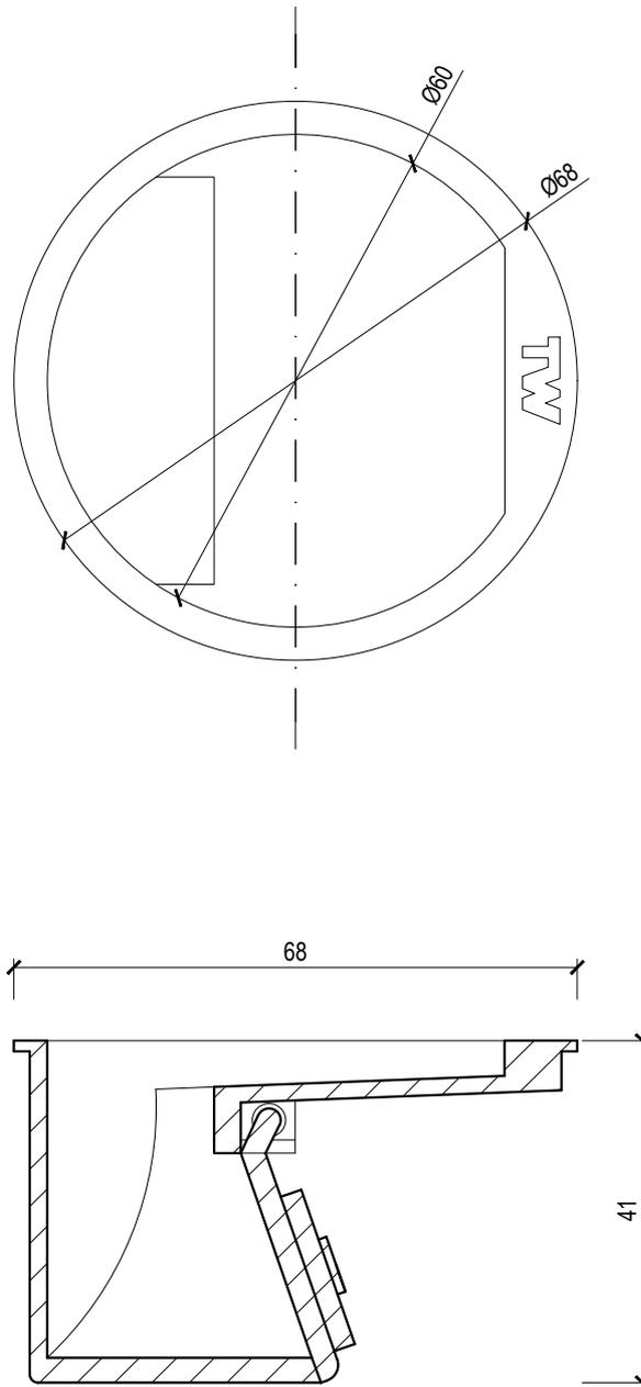
Name **MECHANISCHER GERUCHSVERSCHLUSS FÜR BALKONGULLYS**
